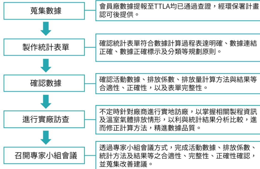
圖 4.6.5 積體電路或半導體排放統計 QA/QC 流程
